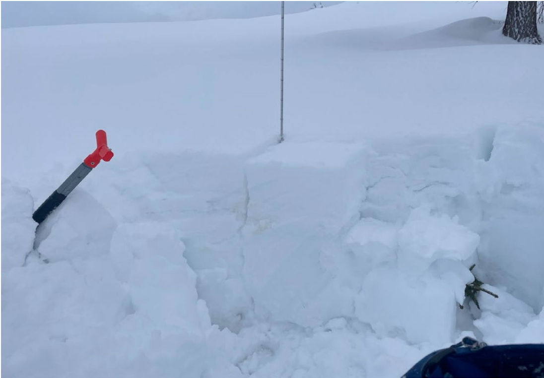
Fig. 19: test di stabilità ECT e foto effettuati il giorno 11/02/2024 in loc. Spinale dal responsabile della sicurezza del comprensorio sciistico di Madonna di Campiglio. HS 113 cm; ECTP16 con frattura a 35 cm dal suolo.
