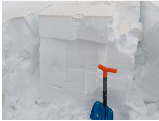
Fig. 2.38, a sinistra: Sotto la Cima d'Accia (Val Sarentino), a 2070 m, era stato rinvenuto uno strato di neve pallottolare di 5 cm di spessore sotto una crosta di 2 cm. (Foto: Peter Payrer, 26/03/2024)
