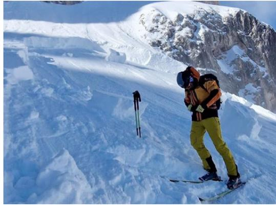
Fig. 2.21, a sinistra: Test del bastoncino sul Silberböden (2200 m, Ladurns): il bastoncino da sci penetrava fino al terreno con poca forza. I cristalli nella parte inferiore del manto nevoso erano molto grandi e poco coesi. Si tratta di cristalli sfaccettati che potevano formare un tipico strato debole. (Foto: Hubert Eisendle, 07.02.2024).
