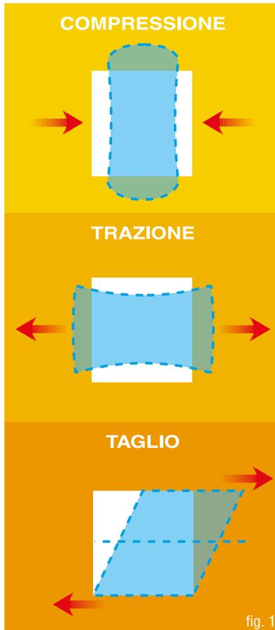
Le sollecitazioni a cui il manto è sottoposto sono essenzialmente **compressione, trazione e taglio** (fig. 1). Ovviamente la capacità di reazione è molto diversa: mentre è relativamente buona per la compressione, possiamo ritenerla piuttosto scarsa, se non pessima, a seconda del tipo di neve e della velocità di sollecitazione, rispettivamente per trazione e taglio.
