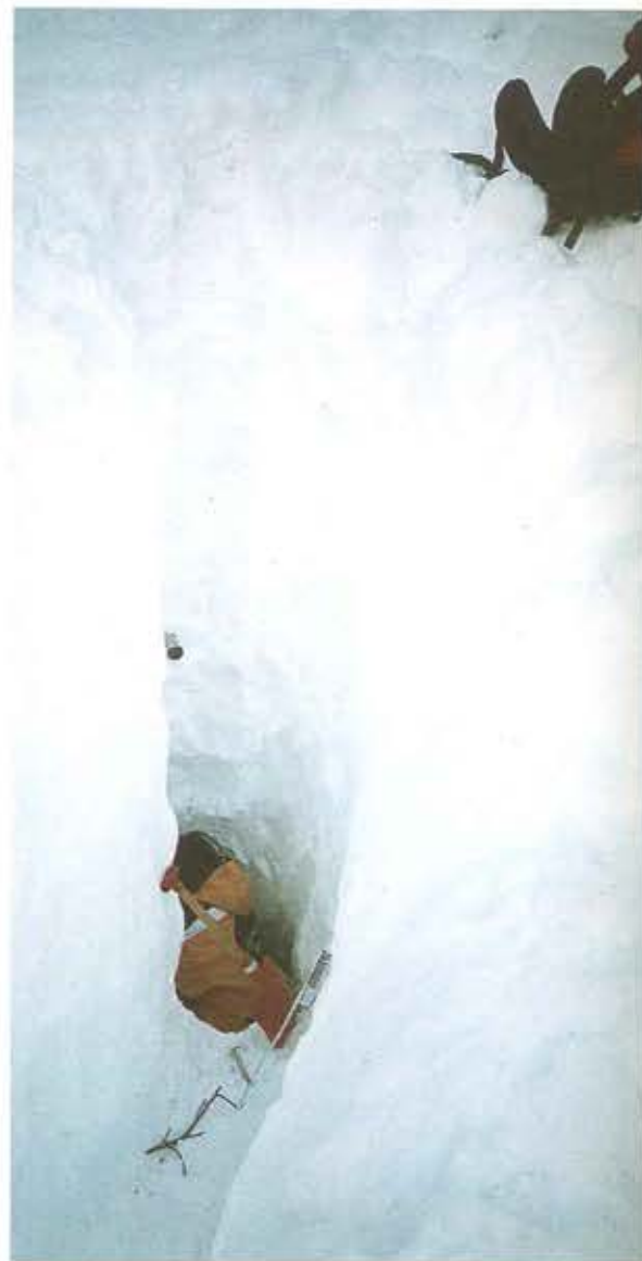
Sopra: misure della densità del deposito della valanga.
