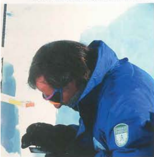
Fig 3 in orari diversi, analisi e prove nel manto nevoso, utili sia per fornire indicazioni sulle caratteristiche fisiche della neve sulle piste di gara, sia per una valutazione areale del pericolo di valanghe (fig. 3). In particolare sono state eseguite prove penetrometriche e stratigrafiche atte a valutare, lungo una sezione del manto nevoso, per i diversi strati, i seguenti parametri: spessore, durezza, forma e dimensione dei cristalli, umidità, temperatura e densità. Con queste informazioni veniva elaborato il profilo stratigrafico della neve (fig 20), che permette di valutare indirettamente il grado di consolidamento del manto nevoso.
