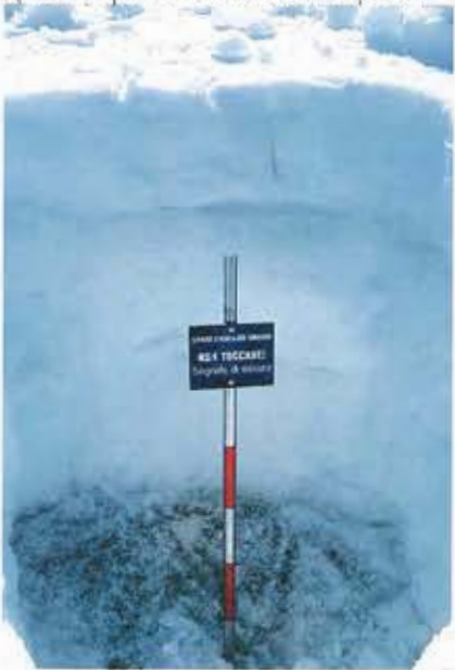
Fig 2 - accumulo in ghiaccio nella stagione 1995/96 e raffronto tra i valori di fusione della Parete NW del Monte Pasquale nelle estati del 1995 e del 1996.
