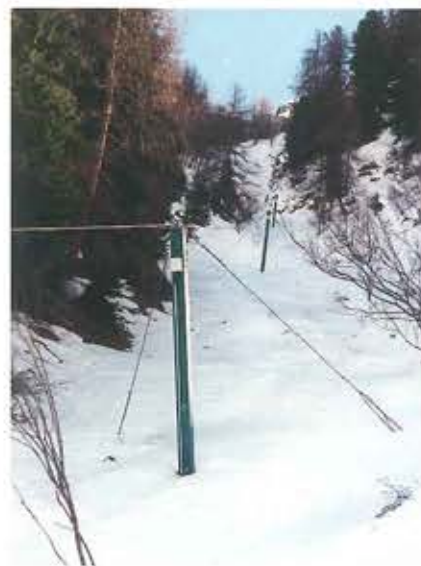
Pagina a fronte: sensore ad asta per la misura della velocità.
