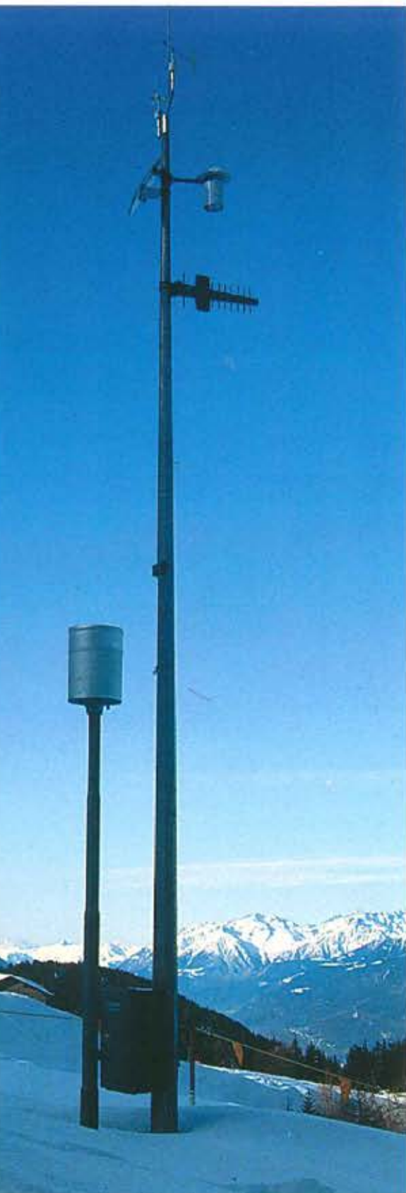
La dislocazione di una stazione automatica per il rilevamento dei dati nivometeorologici deve essere ben valutata in quanto deve permettere di acquisire informazioni attendibili per una zona la più ampia possibile.
