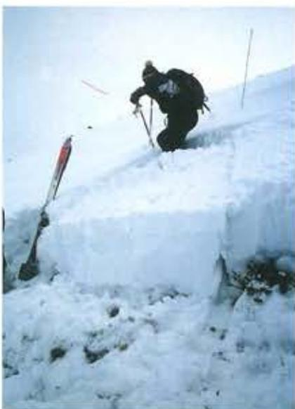
**Sopra: l'entità del distacco presentato nella foto, evidenzia una generale instabilità dello strato superficiale, dovuta alla presenza di uno strato fragile o di un piano di scorrimento.**
