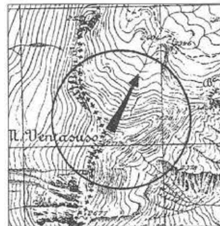
Caratteristiche della valanga: Valanga a lastroni, di neve asciutta a media coesione. Versante ad esposizione NNE inclinazione media 35 gradi. Spessore dello strato staccatosi: 30 cm. Spessore del deposito: minimo 70 cm, massimo 250 cm. Quota massima distacco: 2700 m. Quota minima deposito 2600 m. Cause del distacco: probabile sovraccarico di alpinista a piedi su lastrone da vento.
