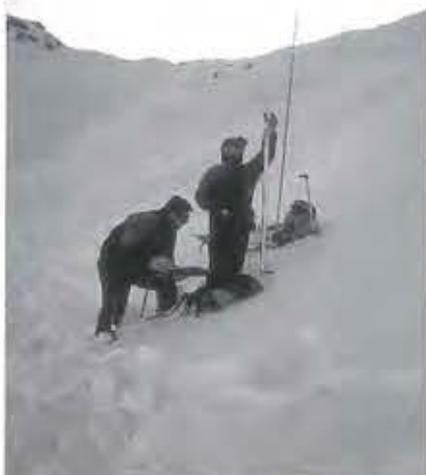
**L'analisi penetrometrica e stratigrafica permette di individuare le resistenze ed il consolidamento del manto nevoso presente su un pendio. Oltre che per lo studio di un incidente, queste informazioni diventano essenziali per la elaborazione del Bollettino Nivometeorologico (esempio sottoriportato).**
