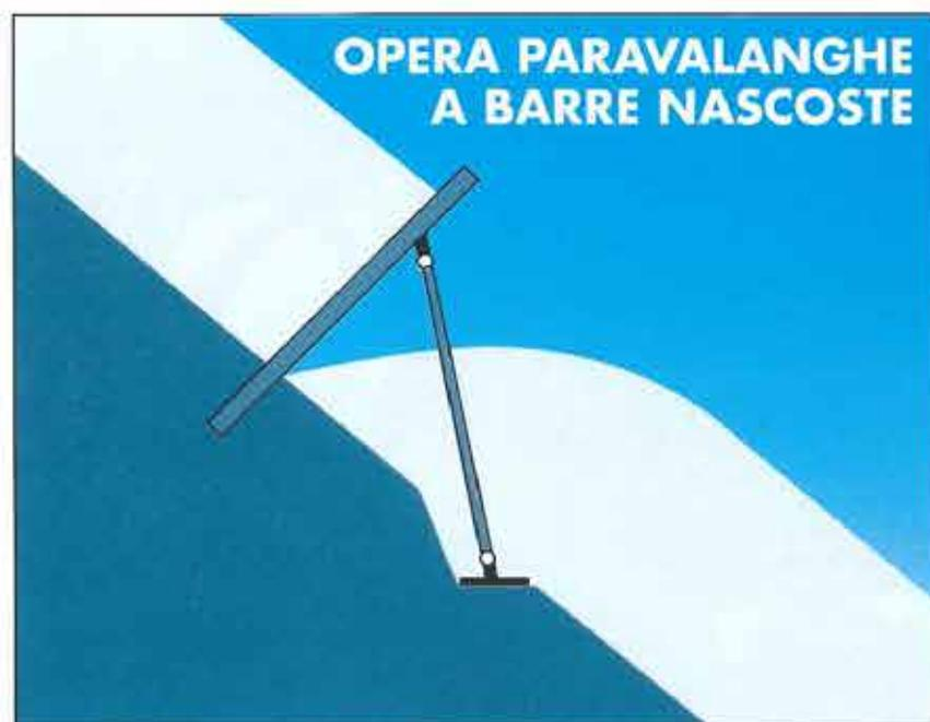
(Sopra): Esempio di applicazione di ancoraggi puntiformi.
