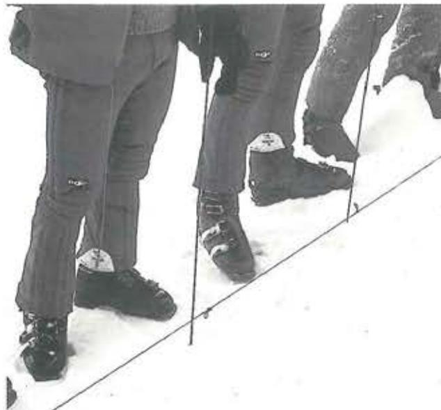
Fig. 4 Sonde allineate ed equidistanti infisse in corrispondenza dei nodi.
