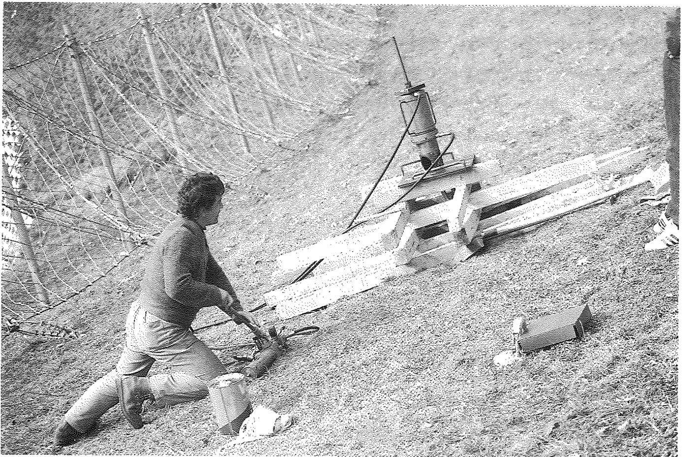
Fig. 5 Prova di resistenza dell'elemento di ancoraggio solidarizzato al terreno mediante "pioio esploso".
