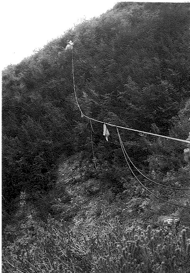
Fig. 3 Sensore sospeso attraverso il canalone su fune \varnothing 12. (Foto: Provincia Autonoma di Trento - Settore Neve e Valanghe)
