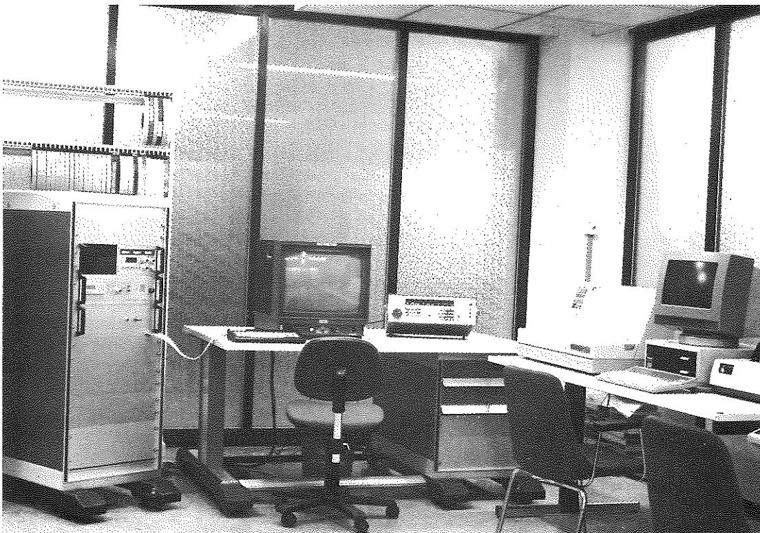
Fig. 6 Sala Situazioni Rischi Naturali: particolare del ricevitore METEOSAT 2, del radio ricevitore RHODE SCHWARTZ con facsimile MUFAX e dell'OLIVETTI M 24 impiegato per la rete nivometrica (Foto Servizio Geologico - O. Ghigo)
