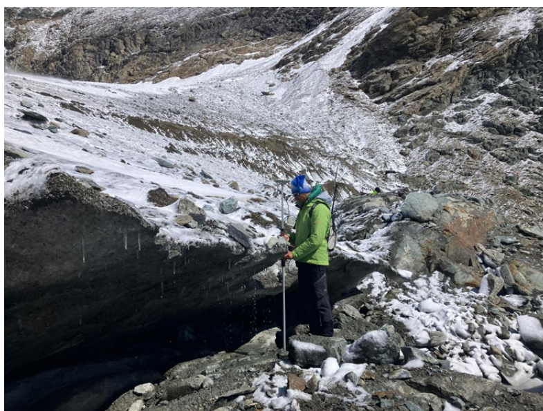
Figura 8: Posizionamento topografico preciso della fronte della Ciamarella con tecnica GNSS differenziale, fonte ARPA Piemonte (foto L. Lanteri, 05/09/2025).
