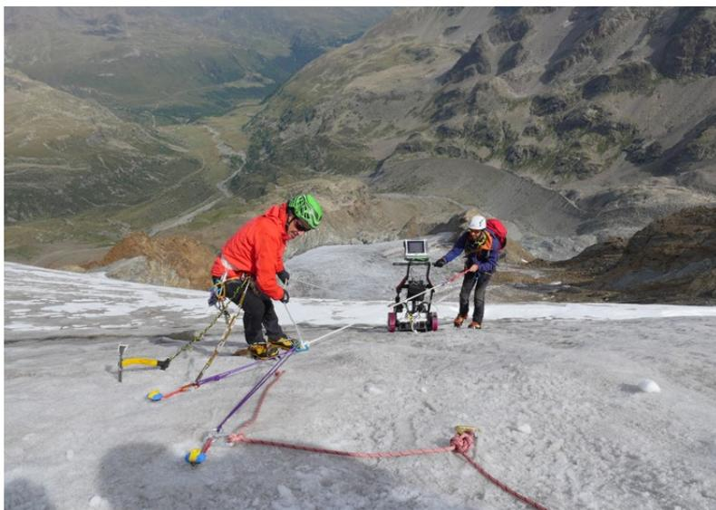
Figura 4 Operazioni di rilievo georadar sez.8
