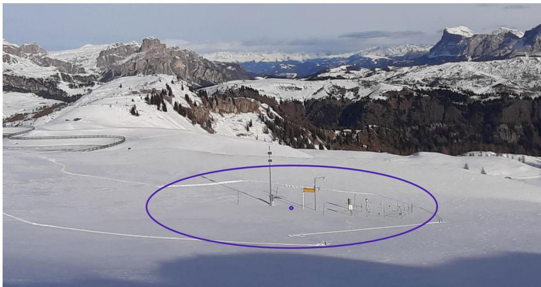
Figura 2. Esempio di footprint del sensore (area con il cerchio azzurro).
