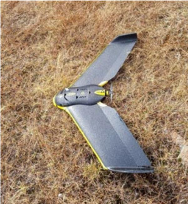
Figura 7 APR utilizzato per il rilievo aerofotogrammetrico
