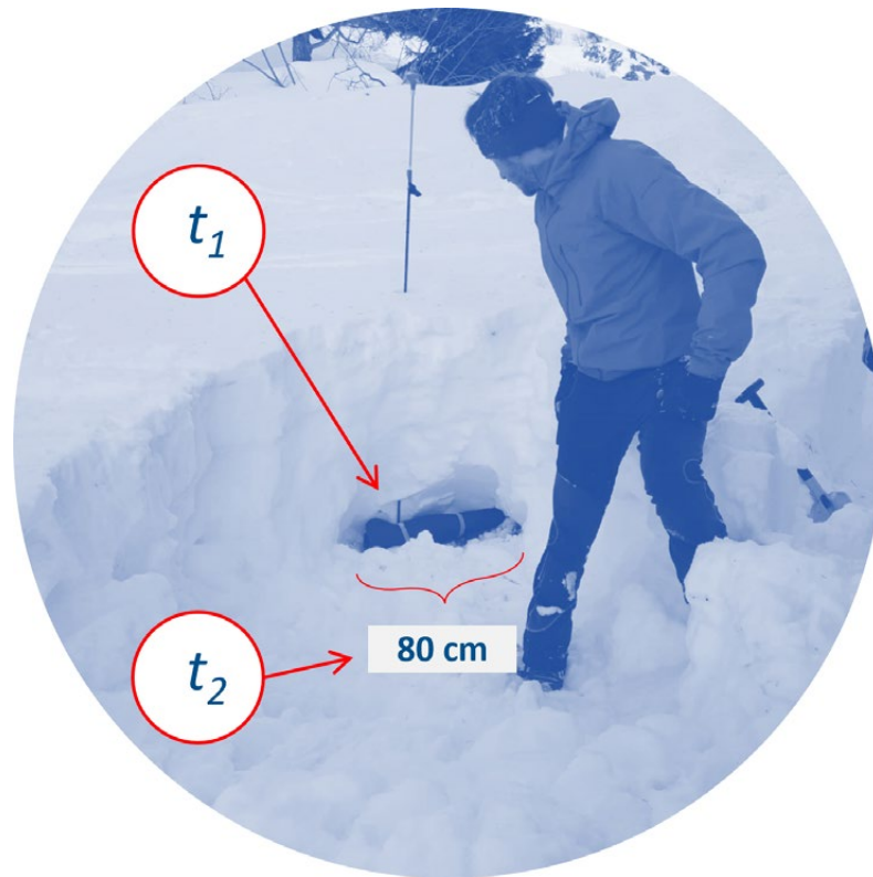
Fig. 2 - I parametri (istanti temporali) misurati: t_1 il raggiungimento della punta della sonda, t_2 l'allargamento della buca tale da accogliere un simulacro fisico di dimensioni predefinite.
