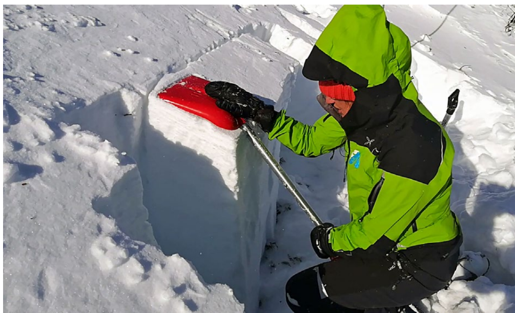
Immagine 2: esecuzione di un ECT, test di stabilità della colonna estesa (Extended Column Test)
