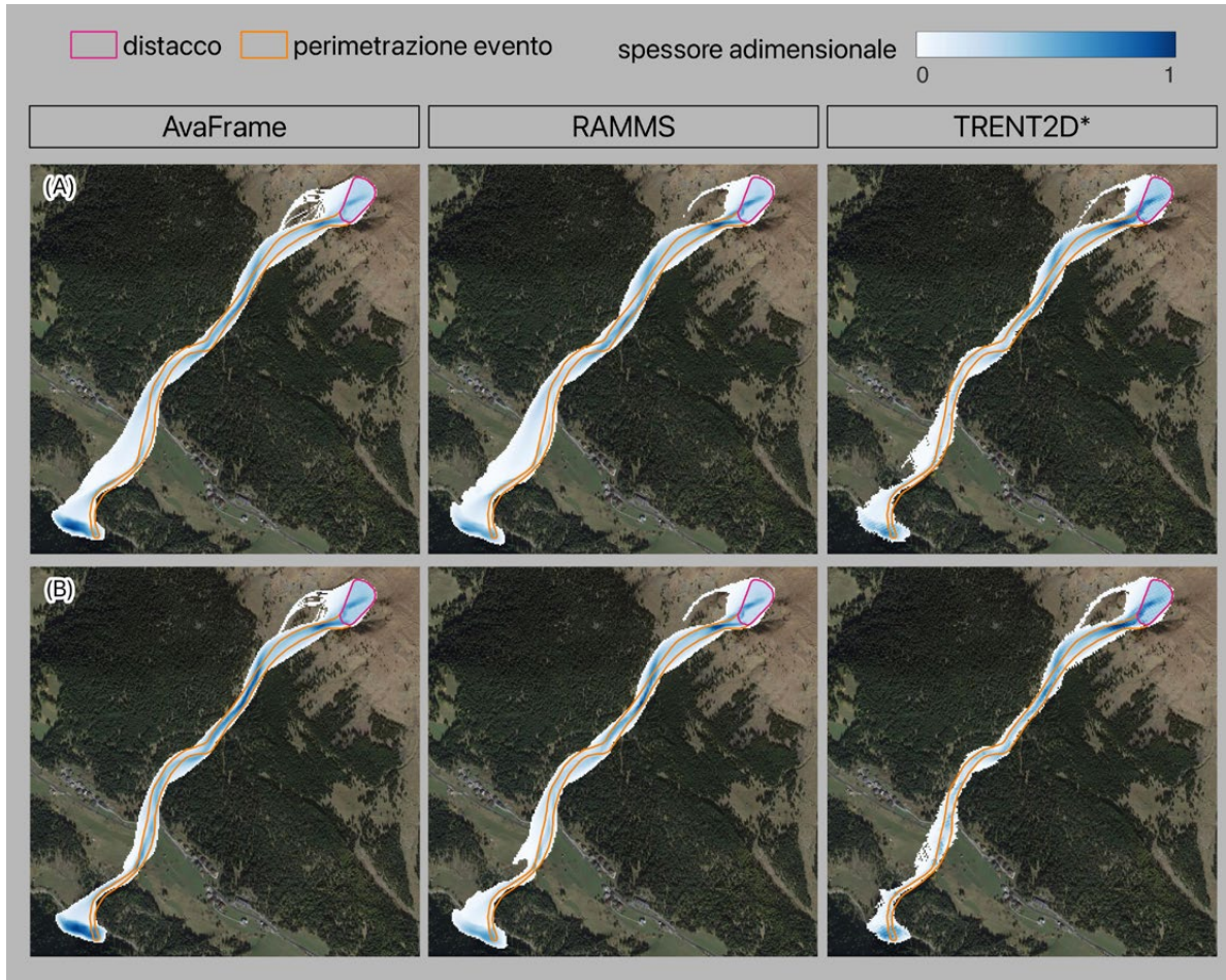
Fig. 5 - Distribuzione dello spessore adimensionale massimo di neve raggiunto, in ogni punto, durante la simulazione per il caso della valanga incanalata in zona dolomitica per i diversi modelli usando (A) \mu=0.28 e \xi=1750 \text{ m/s}^2 e (B) \mu=0.32 e \xi=1350 \text{ m/s}^2 .
