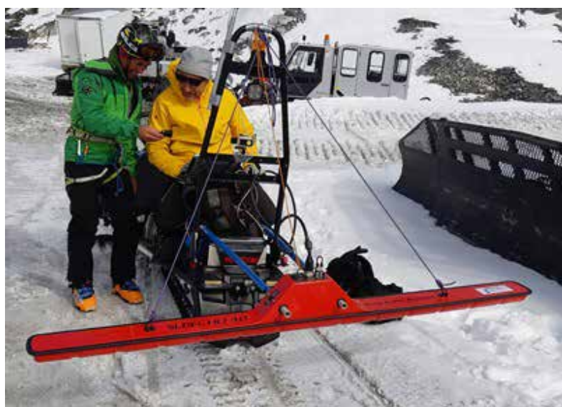
Fig. 4 - Antenna da 40 MHz agganciata alla parte posteriore della motoslitte.
