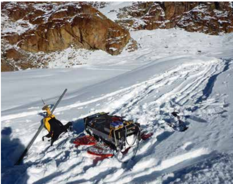
Fig. 6 e 7 - Strumentazione IDS STREAM X a 8 antenne a 200 MHz ed esecuzione rilievi.
