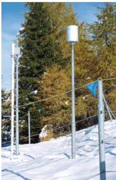
Fig. 2 - Pluviografo elettronico riscaldato CAE PMB2 presso la stazione di Aprica Magnolta (SO).
