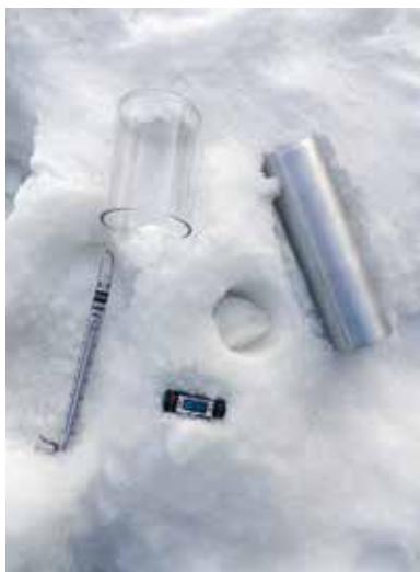
Da sinistra: Fig. 13 - Strumenti manuali di misura della densità del manto nevoso: carotatori e dinamometro.
