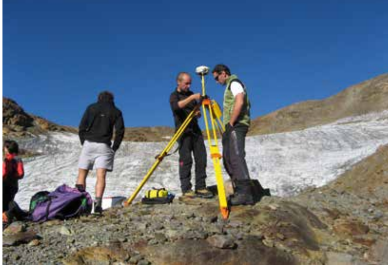
Esecuzione di rilievi GNSS: Stazione fissa (Master).
