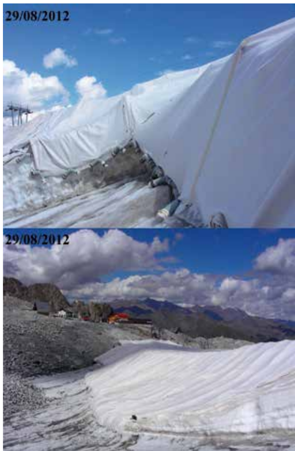
Fig. 11 - Il gradino di neve e ghiaccio testimonia l'efficacia della copertura geotessile a fine agosto.
