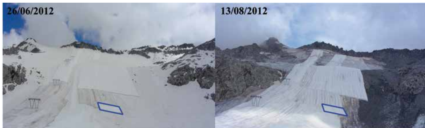
Fig. 2 - Confronto fra due momenti diversi della stagione di ablazione. In entrambe le immagini è stata evidenziata in blu la posizione delle cinque coperture geotessili testate. Nella prima immagine (sinistra) si nota come i teli SI 400 di proprietà della Società Impianti siano caratterizzati da diversi valori di albedo: quelli più scuri erano già stati impiegati nel 2011, mentre quelli più chiari erano nuovi.
