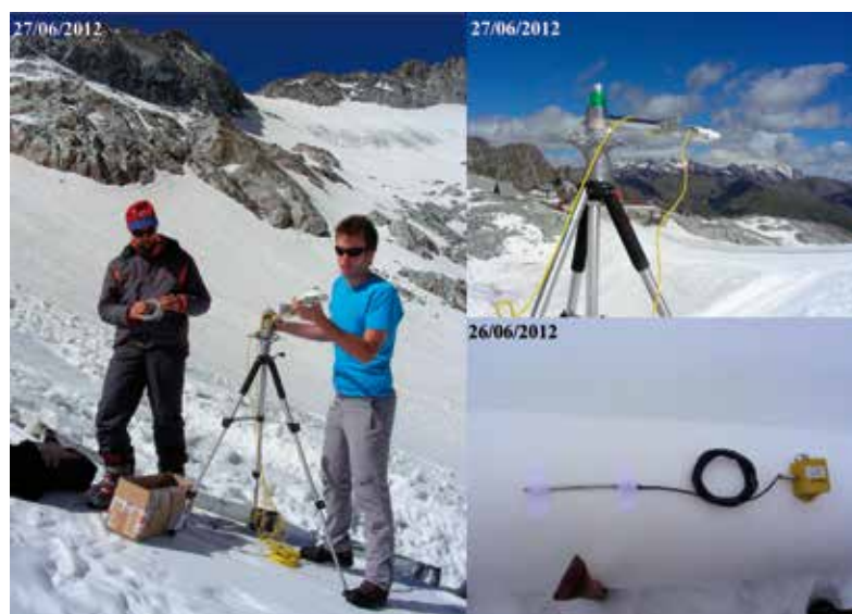
Fig. 3 - Installazione del radiometro per le misure di albedo e dei termistori (in basso a destra) per la misura della temperatura superficiale dei geotessili.
