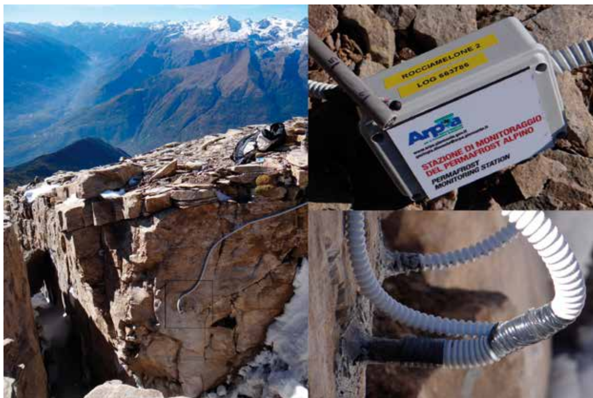
Fig. 9 - Installazione di sensori termometrici in roccia collegati ad un mini-datalogger su una parete di una frattura con apertura metrica sul M. Rocciamelone a circa 3000 m di quota (Provincia di Torino).
