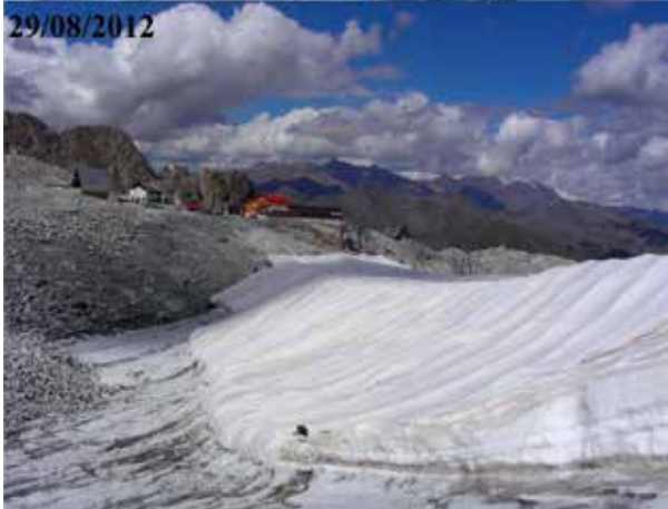
Fig. 11 - Il gradino di neve e ghiaccio testimonia l'efficacia della copertura geotessile a fine agosto.
