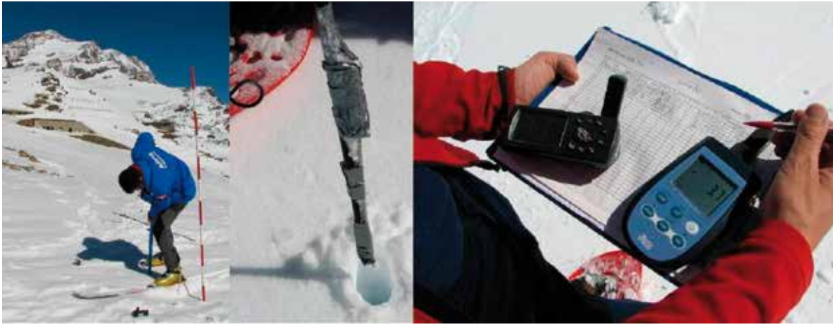
Fig. 4 - Fasi del rilievo BTS. Preparazione del foro di misura nel manto nevoso tramite sonda metallica con punta conica per la perforazione di eventuali croste di ghiaccio (a sinistra), inserimento del termometro a contatto per la misurazione della temperatura della superficie del suolo alla base del manto nevoso (al centro), rilievo con GPS del punto misura BTS e inserimento dei dati nella scheda di rilievo (a destra).
