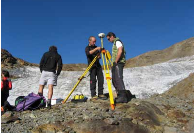
Esecuzione di rilievi GNSS: Stazione fissa (Master).
