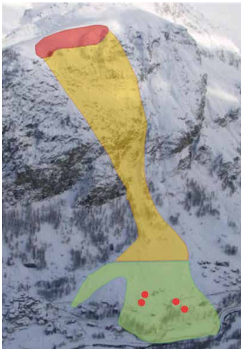
Fig. 1 - In evidenza le zone di distacco (rosso), scorrimento (giallo) e di arresto (verde) della valanga di 039-La Frange del 15 dicembre 2008 in Valsavarenche (AO). Il villaggio di Les Thoules è sito nel fondovalle, in corrispondenza della zona di arresto. I punti rossi indicano le quattro costruzioni interessate dal presente studio (Ufficio Neve e Valanghe - Reg. autonoma Valle d'Aosta; De Biagi et al.).
