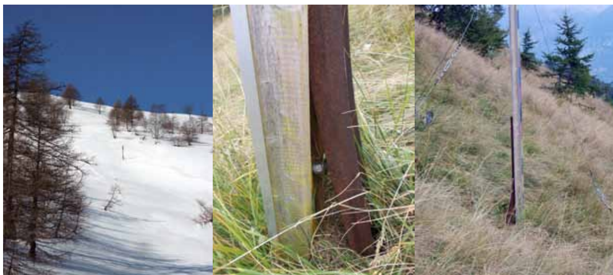
Fig. 7 - Particolare di asta nivometrica in prossimità di gruppi di alberi deformata dai movimenti lenti del manto nevoso all'interno di un accumulo da vento su versante acclive - anno 2012.
