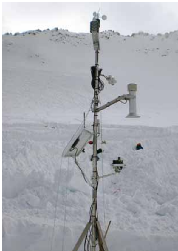
Fig. 2 - Stazione meteorologica automatica (AWS) installata da PAT sul Ghiacciaio Presena (febbraio 2010).
