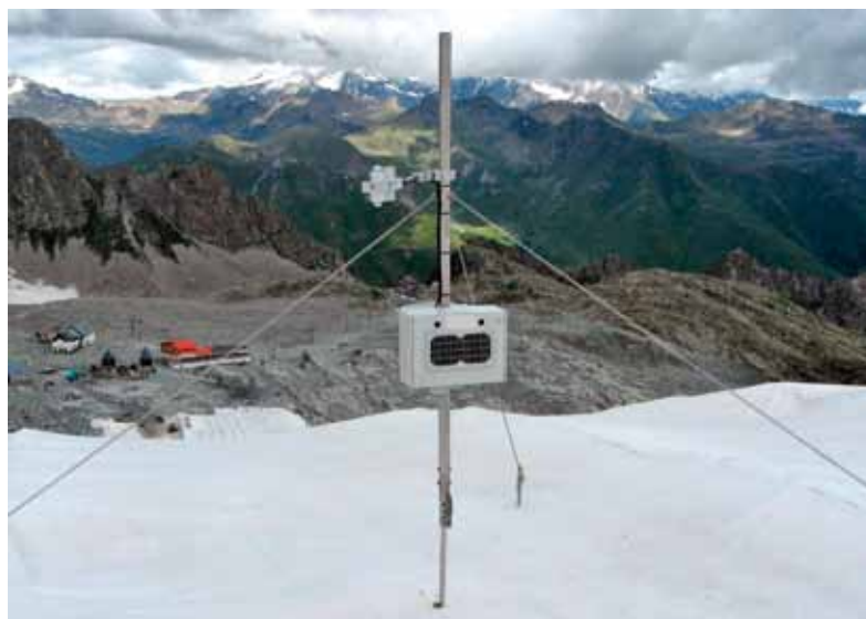
Fig. 8 - Radiometro netto installato sulla superficie della copertura geotessile posizionata sul Ghiacciaio Presena.
