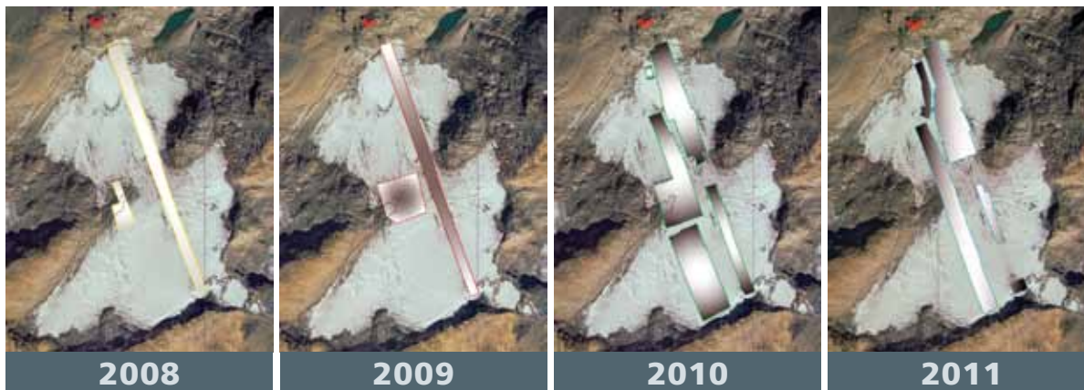
Fig. 1 - Localizzazione della copertura geotessile sulla superficie del Ghiacciaio Presena nei diversi anni di sperimentazione di questa strategia di protezione glaciale attiva (da sinistra a destra copertura 2008, 2009, 2010, 2011).
