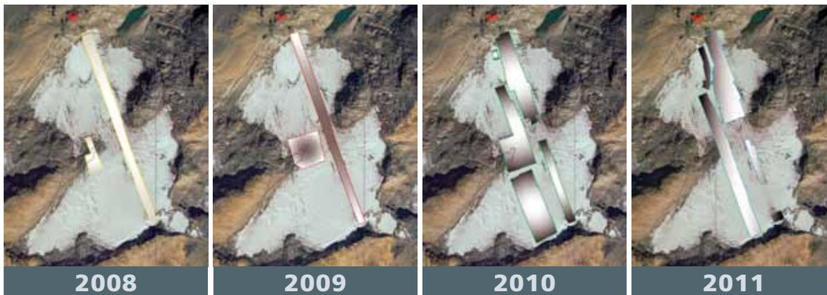
Fig. 1 - Localizzazione della copertura geotessile sulla superficie del Ghiacciaio Presena nei diversi anni di sperimentazione di questa strategia di protezione glaciale attiva (da sinistra a destra copertura 2008, 2009, 2010, 2011).
