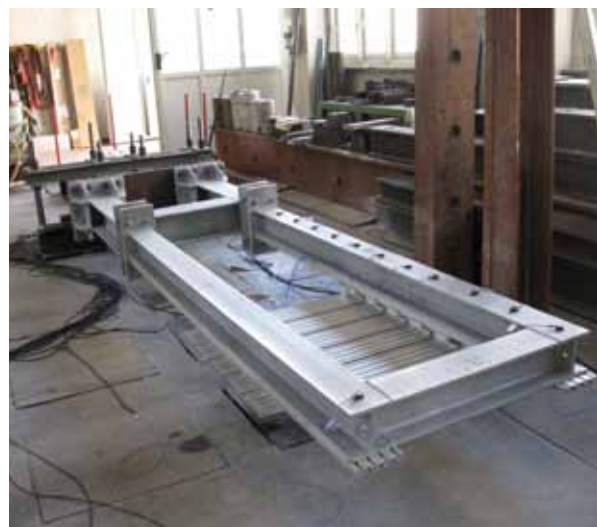
Fig. 8 - Installazione del bersaglio in laboratorio MASTRLAB del DISTR - Politecnico di Torino per le prove statiche e dinamiche. Si nota la riproduzione del vincolo della fondazione grazie ad un telaio di contrasto in acciaio, ancorato al pavimento.
