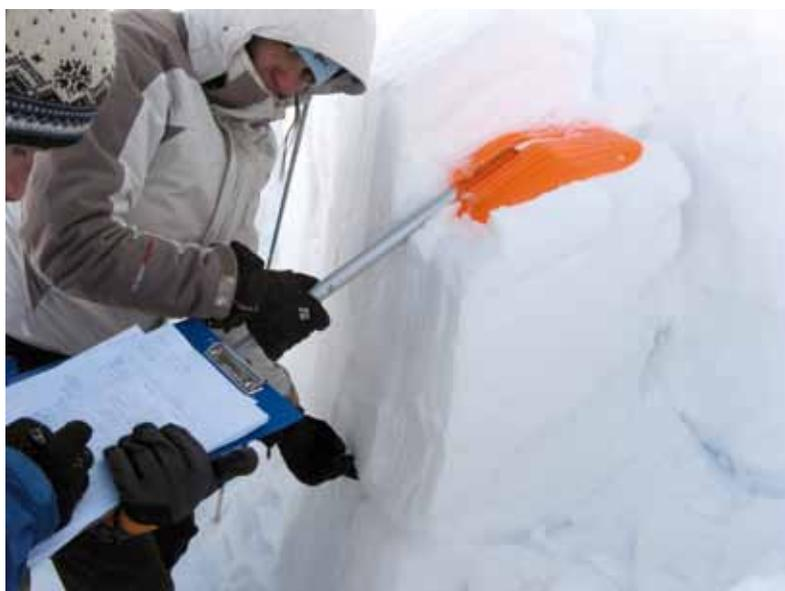
*Fig. 5 - Esecuzione di un Extended Column Test.*
