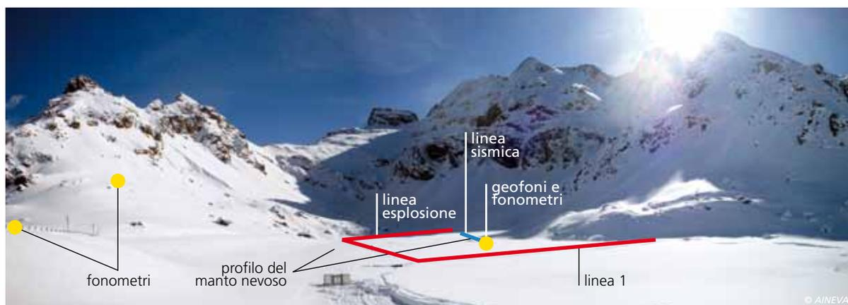
Fig. 5 - LINEA 1: schema di posizionamento cariche di Gelatina Dinamite in funzione dell'altezza di scoppio e della quantità di carica. Sono qui indicati i primi due set di tiri con un'altezza di scoppio di -0.5 m e 0 m (carica in manto e appoggiata). La sequenza delle detonazioni è controllata dall'altezza di scoppio e dalla quantità di carica.
