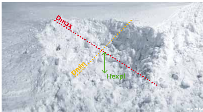
Fig. 7 - Misure della geometria del cratere originato dall'esplosione.
