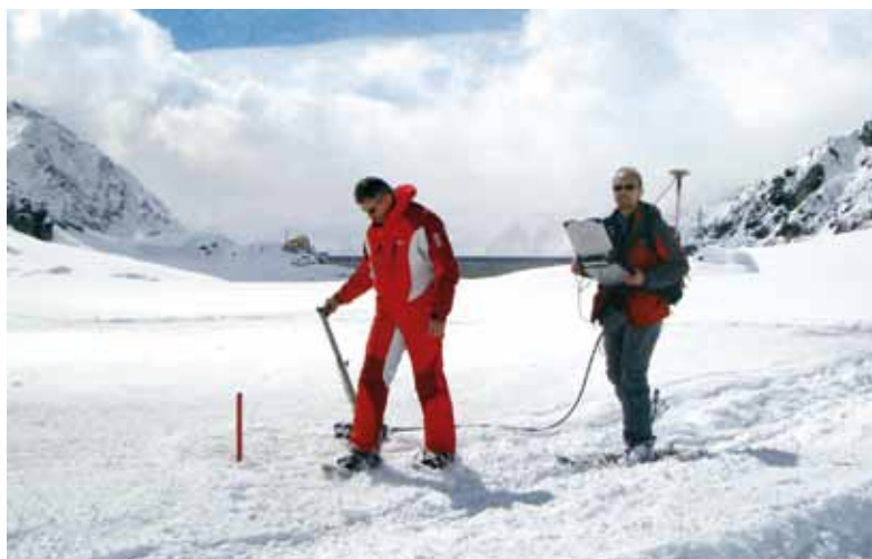
Fig. 8 - Esecuzione del profilo georadar lungo la linea di tiro nella fase di pre esplosioni.
