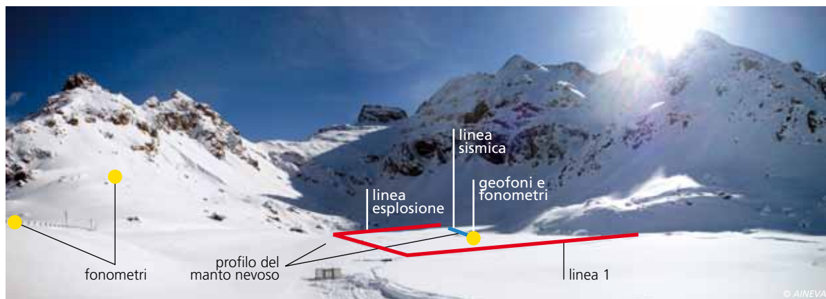
Fig. 4 - Vista del campo prove il giorno 31 marzo 2010. Sono indicati: la linea di tiro (in rosso), la traccia dello stendimento geosismico (in blu) e i differenti punti monitoraggio.
