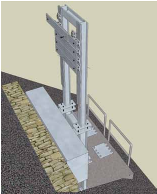
Dall'alto verso il basso: fig. 1 - Vista d'insieme dell'ostacolo impattato dal fenomeno valanghivo del 5 marzo 2011; fig. 2 - Rendering tridimensionale d'insieme del sistema integrato per la rilevazione delle forze di impatto da valanghe di neve al sito della P.ta Seehore.
