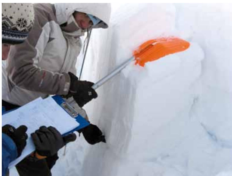
Fig. 5 - Esecuzione di un Extended Column Test.
