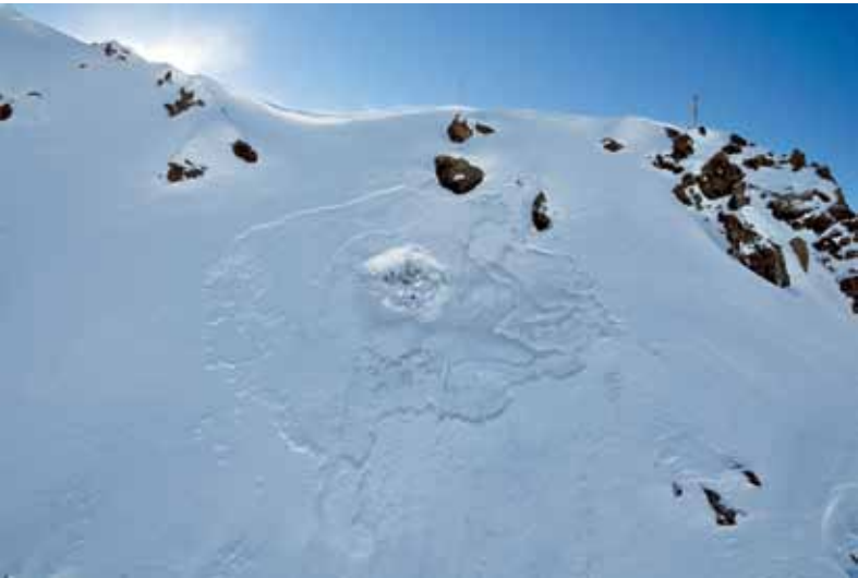
Fig. 4 - Cratere generato a seguito del distacco operato con la DaisyBell in occasione della prova sperimentale del 1 marzo 2011 (Fonte: Arnoldo Welf).
