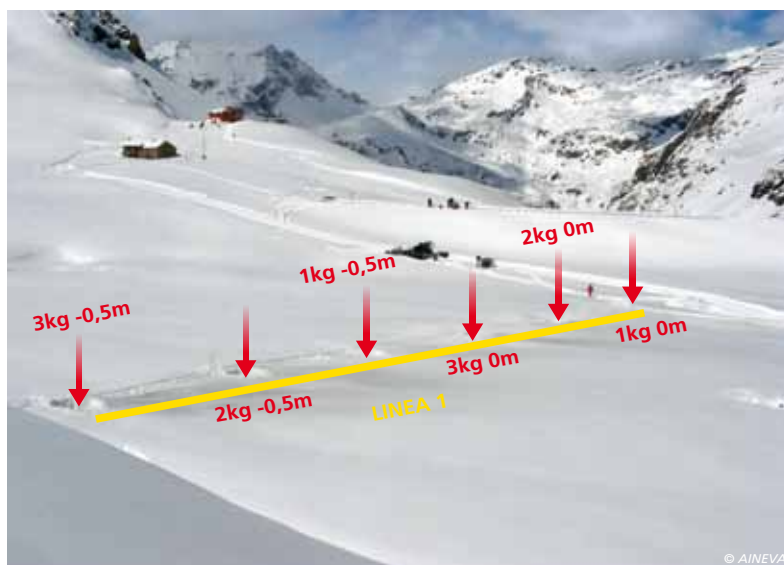
Fig. 5 - LINEA 1: schema di posizionamento cariche di Gelatina Dinamite in funzione dell'altezza di scoppio e della quantità di carica. Sono qui indicati i primi due set di tiri con un'altezza di scoppio di -0.5 m e 0 m (carica in manto e appoggiata). La sequenza delle detonazioni è controllata dall'altezza di scoppio e dalla quantità di carica.
