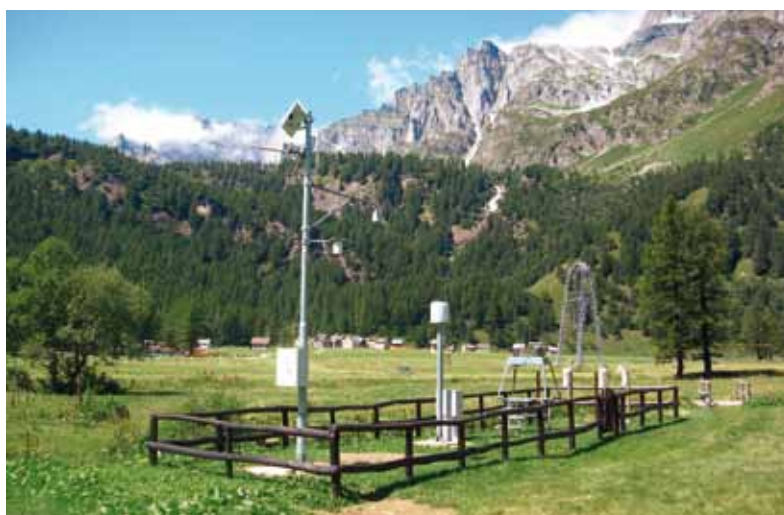
Fig. 4 - Stazione nivometeorologica automatica di Alpe Devero.
