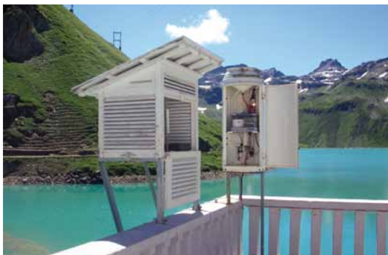
Fig. 3 - Stazione nivometeorologica manuale di Formazza Vannino - cabina meteorologica e pluviografo.
