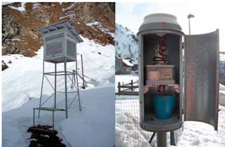
Fig. 2 - Stazione nivometeorologica manuale di Alpe Cavalli - cabina meteorologica e pluviografo.
