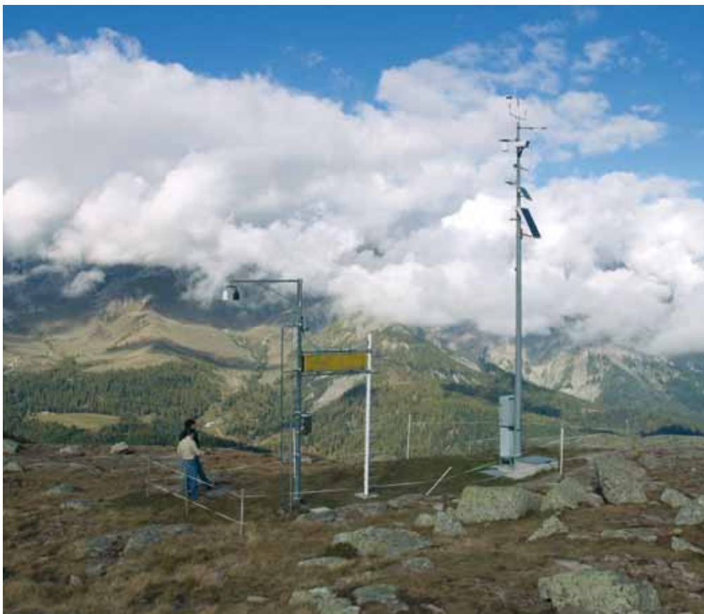
Fig. 1 - Stazione di monitoraggio di Cima Pradazzo. Sul palo principale sono fissate le due webcam.
