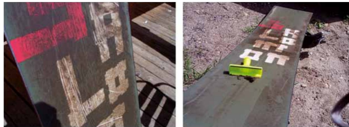
Fig. 2 - Campionamento del materiale colloso dalla soletta di uno snowboard (Prati, TO).
