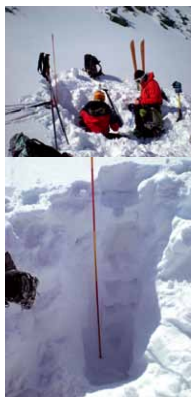
Fig. 2 - (a) Escavazione di trincea per rilievo della densità media del manto nevoso con tecnica classica. (b) Profilo verticale della trincea per la misura della densità media del manto nevoso. Sono visibili le impronte lasciate dal carotatore [Campagna rilievo 2009].
