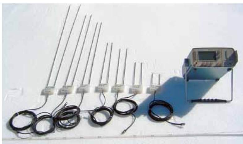
Fig. 7 - Strumentazione utilizzata nel rilievo: TDR cable tester TEKTRONIX 1502C e kit di sonde a due conduttori metallici paralleli di differente lunghezza.
