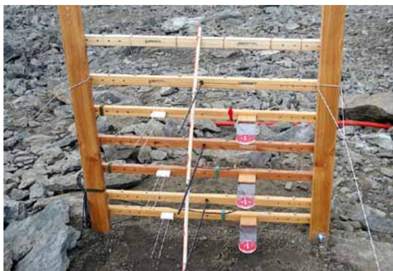
Fig. 11 - Stazione di monitoraggio installata nel 2008. I sostegni in legno e il palo in plexiglas sono destinati alle piastre di flusso, ai sensori WCR e alle sonde di temperatura.
