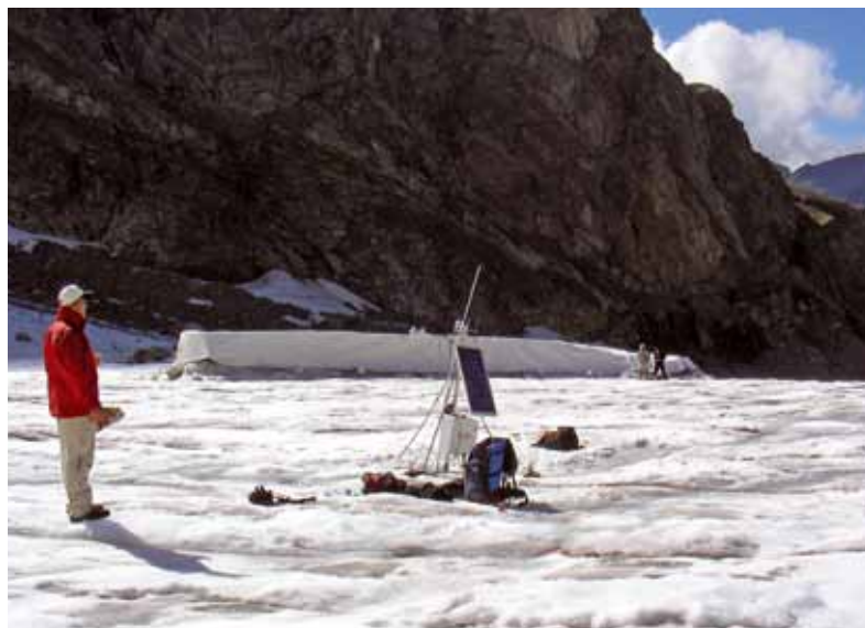
Fig. 8 La superficie ricoperta con geotessile in un'immagine del 19 Agosto 2008. In primo piano la stazione meteorologica automatica AWS Dosdè-Levissima (foto G. Diolaiuti).
