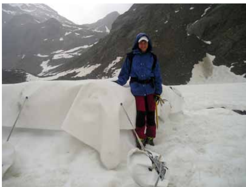
Fig. 7 Immagini della copertura nevosa sottoposta a protezione con il geotessile durante le operazioni di manutenzione eseguite il 23 Luglio 2008 (valore medio spessore neve protetta 120 cm). I ricercatori sollevano il telo per verificare le condizioni della neve e provvedono a riposizionarlo allungando le fettucce statiche (foto D. Maragno).
