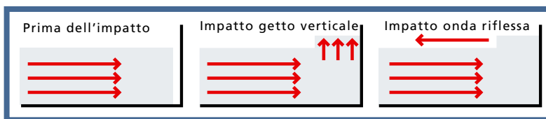
Fig. 12 Schema dei due tipi di impatto per una mistura trifasica secondo Armanini, Scotton (1993).
