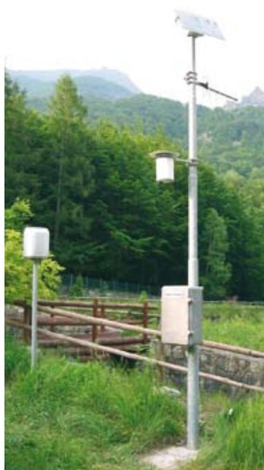
Fig. 6 - Stazione meteorologica ARPA di Ala di Stura (foto: ARPA Piemonte, Banca Dati Meteorologica 1990-2003, cd).
