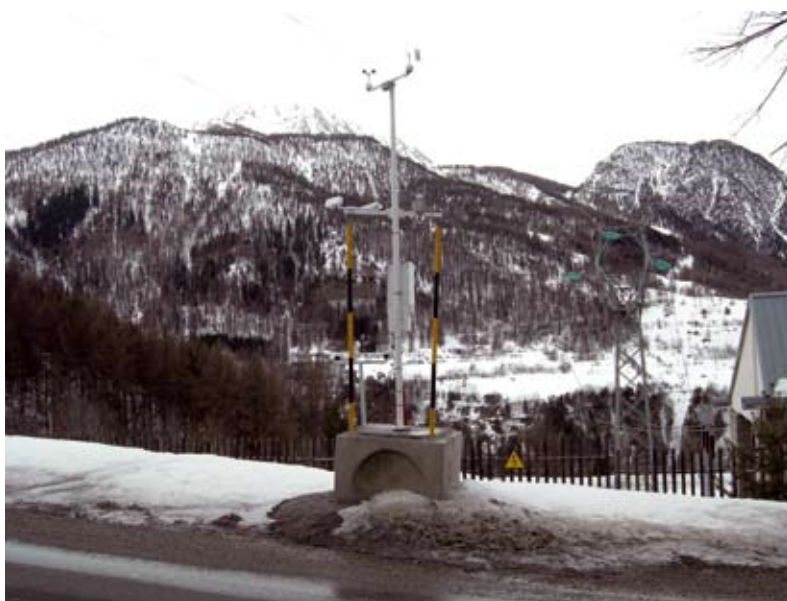
Fig. 3 - stazioni di monitoraggio installate rispettivamente in Val Chisone ed in Val Susa. Le due stazioni, oltre a sensori meteorologici standard (temperatura ed umidità relativa dell'aria, velocità e direzione del vento, sensore di tempo presente), comprendono anche un sensore, come è possibile vedere dall'ultima immagine, installato nel manto stradale, che fornisce misure di temperatura e stato della superficie stradale (asciutto, umido, bagnato, ghiacciato, trattato con agenti antigelo ecc.).
