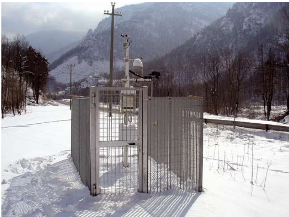
Fig. 3 - stazioni di monitoraggio installate rispettivamente in Val Chisone ed in Val Susa. Le due stazioni, oltre a sensori meteorologici standard (temperatura ed umidità relativa dell'aria, velocità e direzione del vento, sensore di tempo presente), comprendono anche un sensore, come è possibile vedere dall'ultima immagine, installato nel manto stradale, che fornisce misure di temperatura e stato della superficie stradale (asciutto, umido, bagnato, ghiacciato, trattato con agenti antigelo ecc.).
