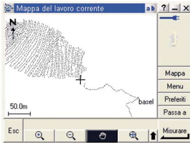
Fig. 6 - Il percorso seguito da un operatore rappresentato nella mappa vettoriale a bordo del dispositivo controller.
