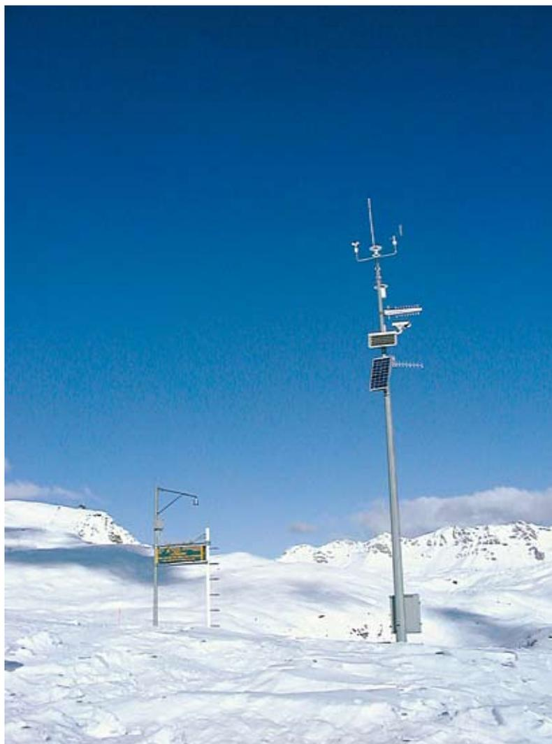
Fig. 3 - Stazione nivometeorologica automatica
