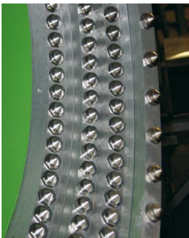
Cannoni a ventola con dettaglio sugli ugelli (sotto).
