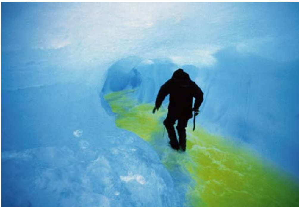
Sopra: Patagonia, Argentina. Colorazione idrogeologica in una galleria attiva nel ghiacciaio Perito Moreno.
