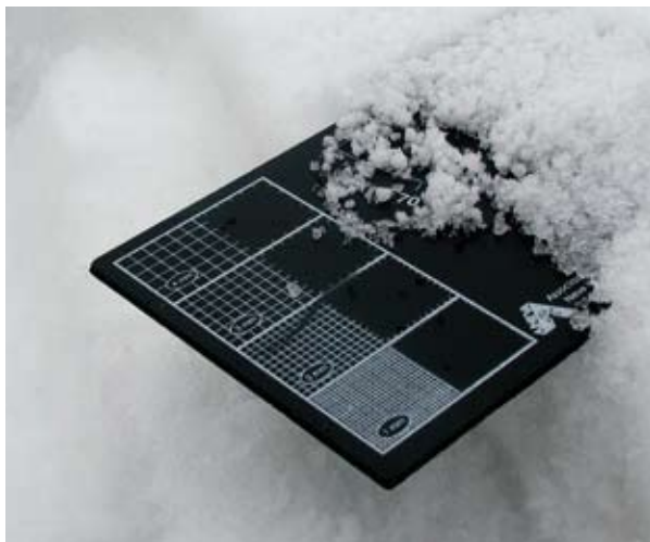
Comparazione fra le classi del test della mano, area specifica e durezza
