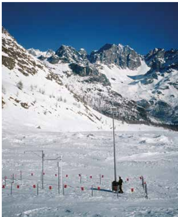
Fig. 3 Nivometro per la misura dello spessore del manto nevoso e termometro per la misura della temperatura della neve.
