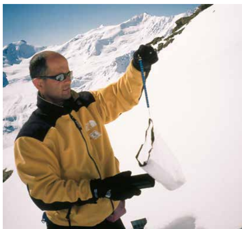
Fig. 5: Peso del campione di neve attraverso un dinamometro a molla.
