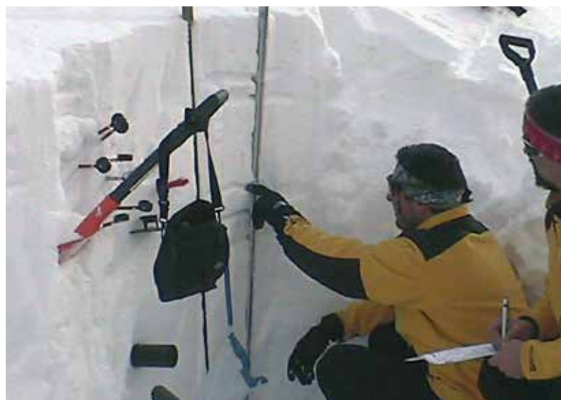
Fig. 4: Misura stratigrafica della temperatura della neve.
