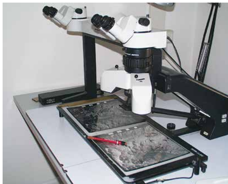
Fig. 8 Stereoscopio che, nella redazione delle CLPV, viene utilizzato per eseguire lo studio aerofotogrammetrico.
