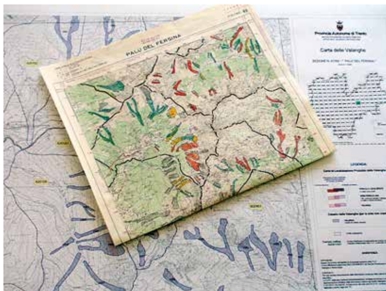
Fig. 6 Confronto tra le vecchie mappe del Catasto Valanghe in scala 1:25.000 e le nuove in scala 1:10.000
